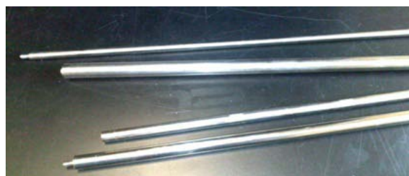
Figura 5. Veios retirados de impressoras.
