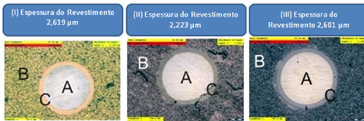
Figura 2. Corpo de prova para avaliação da adesividade e a espessura da camada dos revestimentos de TiN (I), AlTiCN (II) e AlTiCrN (III).
