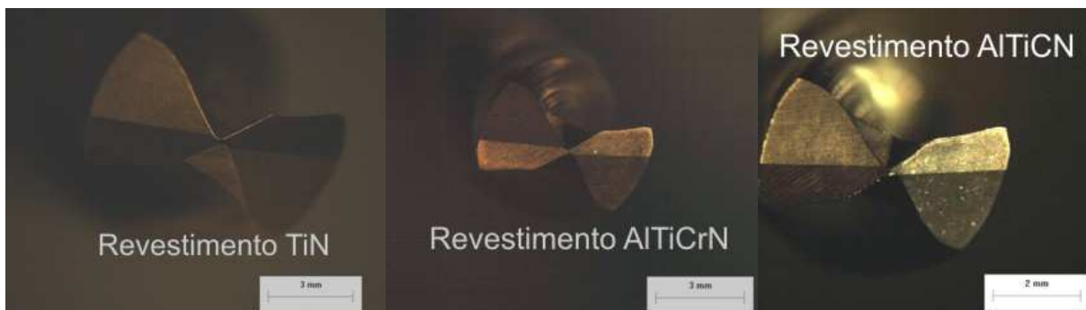
Figura 1. Brocas helicoidais DIN 338 Ø 6 mm com revestimento de TiN (a), AlTiCN (b) e AlTiCrN (c).
