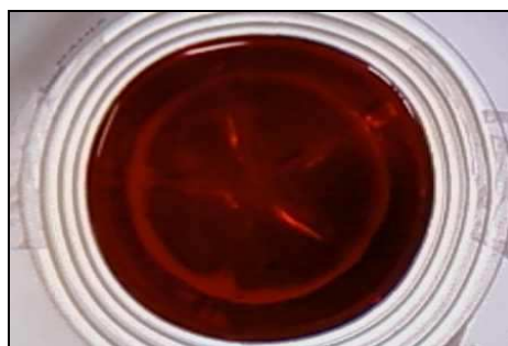
Figura 1. Amostra FSF da fibra de coco em uma solução de acetona/água na 1ª lavagem.
