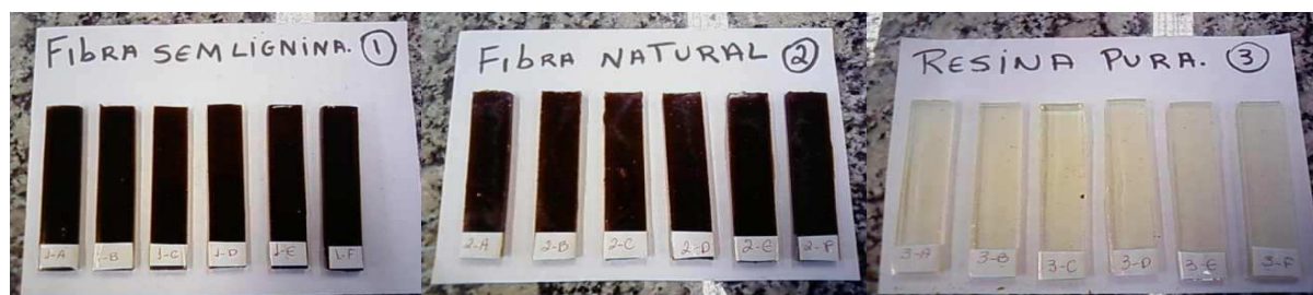
Figura 3. Corpos de prova para teste de flexão em equipamento de ensaio universal.
