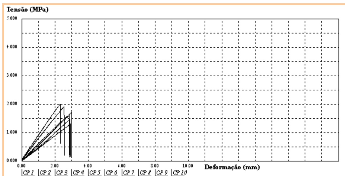
Figura 8. Ensaio de flexão a três pontos para compósitos a base de poliéster ortoftálico e 5% p/p de fibra de coco isenta de lignina.
