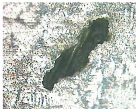
Figura 2. Detalhe de uma imperfeição na estrutura do espaçador (aumento 10x).
