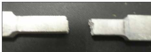
Figura 4. Corpos de prova destruídos após o ensaio.
