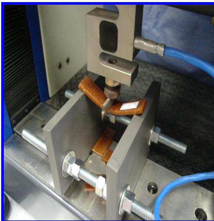
Figura 1: Teste de flexão segundo norma NBR 7447 em equipamento de ensaio universal
