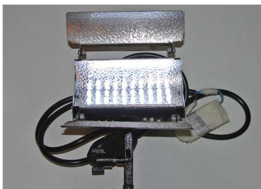
Figura 4 - Iluminador com LEDs e sua bateria composta por duas células de Li-Íon.
