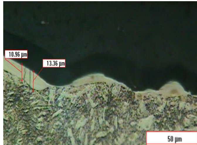
Figura 02 Aço AISI H 13 da Série 01, ataque de Nital a 2%
