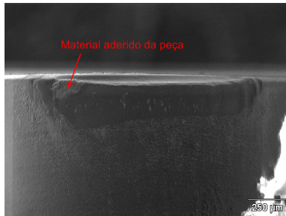
Figura 5. Desgaste de flanco na liga L1 aos 6,19 minutos de usinagem, com v_c= 500 m/min com ferramenta cerâmica pura.
