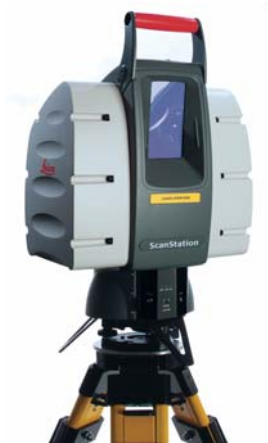
Figura 4. Equipamento Laser Scan 3D - Leica
