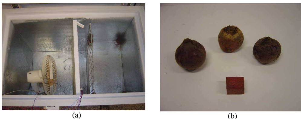
Figura 2. (a) Arranjo interno do freezer com uma amostra de beterraba tridimensional pronta para o experimento de congelamento. (b) Amostra em forma de paralelepípedo recortada de bulbos de beterraba.
