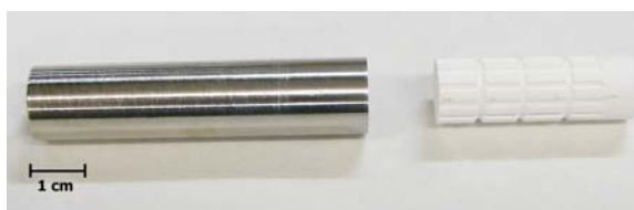
Figura 3. Vista do evaporador capilar e o meio poroso cerâmico.
