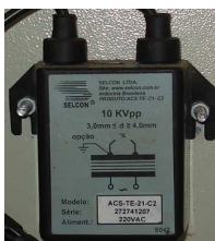
Figura 7: Transformador de alta tensão selcon
