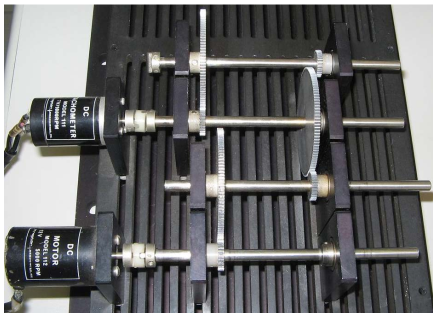
Figura 2. Servomecanismo formado por motor DC e tacômetro
