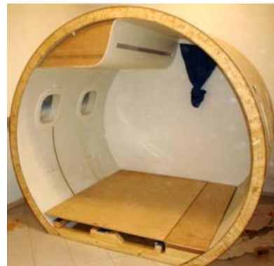
(b) Montagem após colocação de pisos e sistema de iluminação
