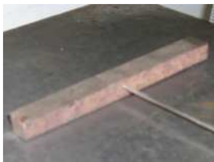
Figura 3. Corpo de Prova (10 x 10 x100) mm retirado no sentido longitudinal do duto.
