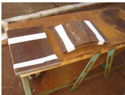
Figura 2. Material utilizado reduzido a chapas (Setor circular de dutos).
