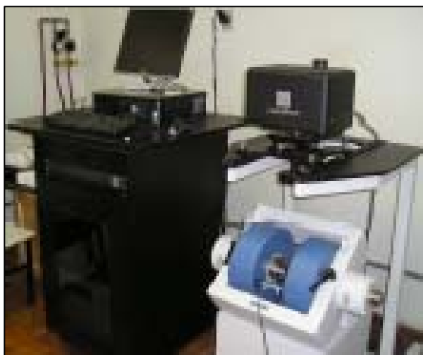
Figura 4. Magnetômetro de Amostra Vibrante Lake Shore Model 7004.
