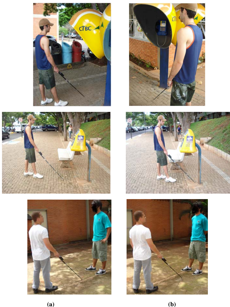
Figura 11. Testes experimentais. (a) Movimentação sem colisão; (b) Instante da detecção do obstáculo.
