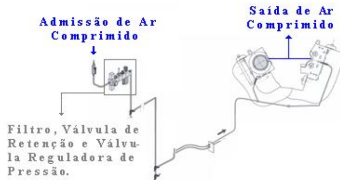
Figura 15 – Sistema de limpeza da região trabalhada
