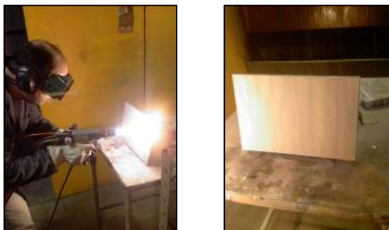
Figura 4- Revestimento por aspersão térmica sobre chapa plana.
