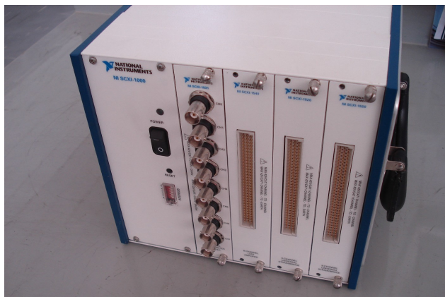
Figura 2. Foto do módulo condicionador de sinal SCXI-1000.
