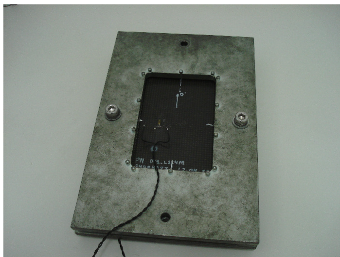
Figura 9. Foto do quadro de metal com o laminado posicionado no centro
