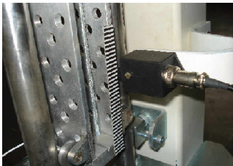
Figura 5. Régua escalonada com listras pretas colada no impactador.
