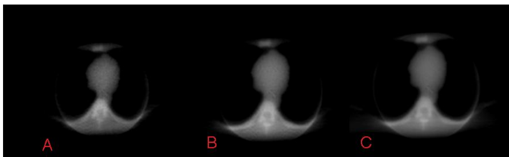
Figura 8. Imagens adquiridas com ângulo de abertura do feixe de 25°. (A) 360 vistas e 500 fótons/linha; (B) 360 vistas e 4000 fótons/linha e (C) 720 vistas e 4000 fótons/linha.
