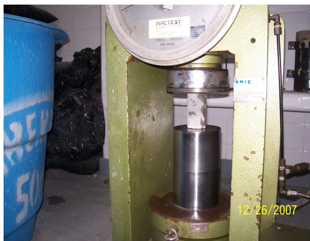
Foto 3.4 – Corpo de prova de RPC sendo testado à compressão.
