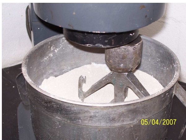
Foto 3.1 – Material seco em processo de mistura para produção do RPC
