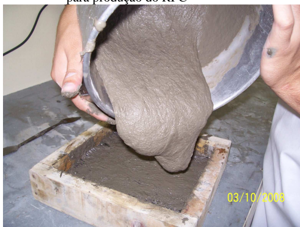
Foto 3.3 – RPC sendo vertido em formas
