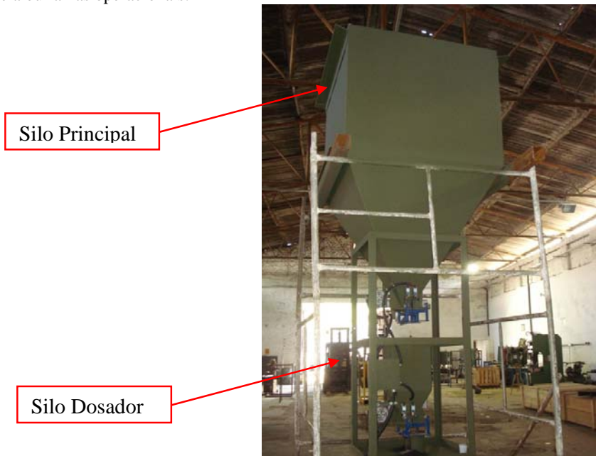
Figura 7 – Silos – Imagem do Autor
