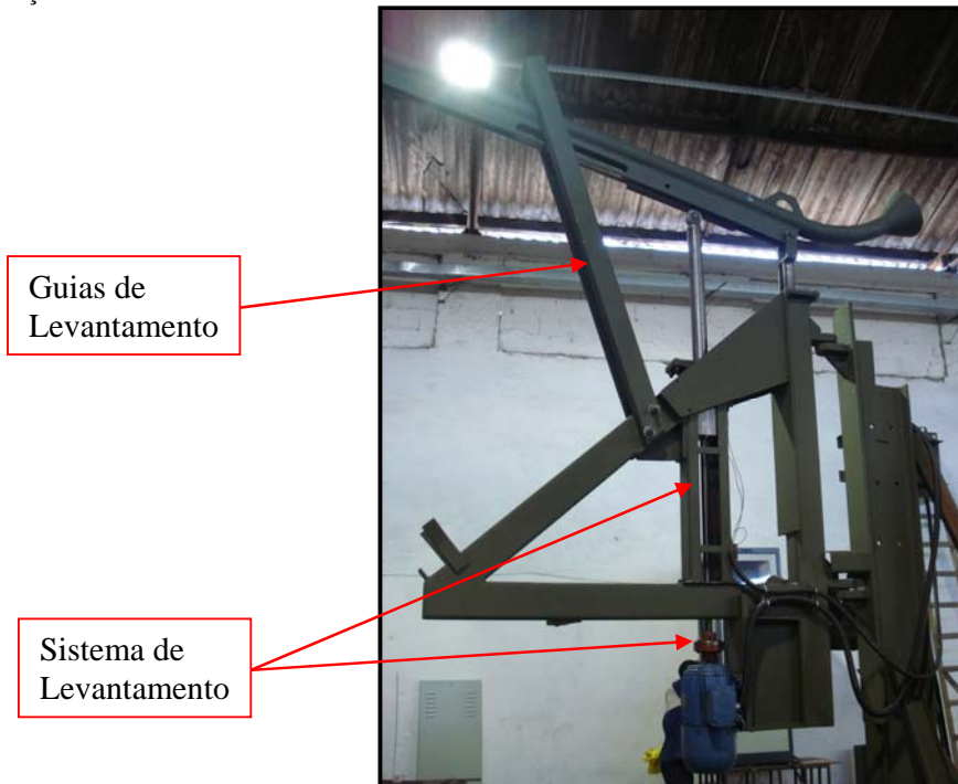
Figura 3 – Guias do sistema de levantamento – Imagem do Autor
