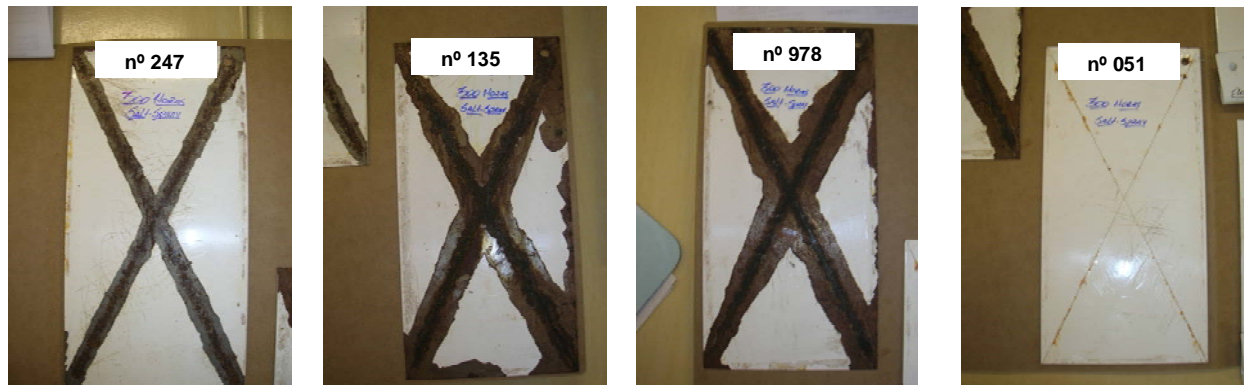
Figura 2. Foto das placas nºs 247,135, 978 e 051 que foram submetidas ao teste de Névoa Salina na empresa “T”.
