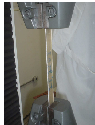
Figure 3. Longitudinal tensile strength test.
