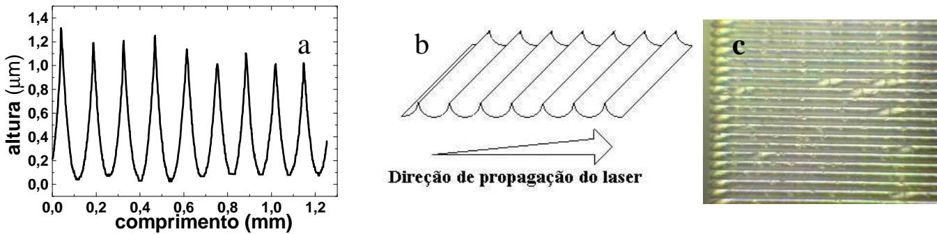
Figura 2 – a) Perfil de amostra de vidro soda-lime após irradiação com laser de CO 2 . b) Conforme a ilustração, as ranhuras são formadas no sentido perpendicular à propagação do laser devido à modulação de potência do mesmo. c) micrografia de amostra de vidro soda-lime com perfil periódico gerado por laser. A separação entre cada ranhura é de 150 μm.
