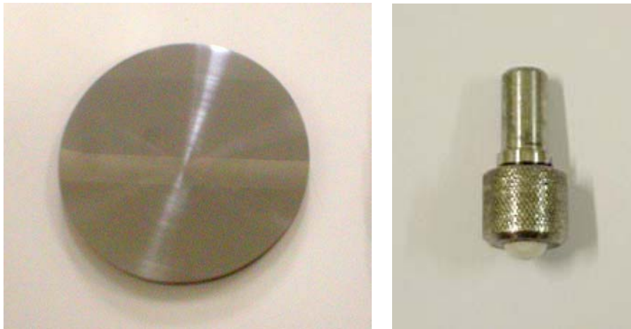
Figura 1. Disco ou contra face de aço 422 e esfera de zirconia presa ao suporte.
