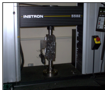
Figura 3. Dispositivo para ensaio de cisalhamento planar simples montado na máquina de ensaios.
