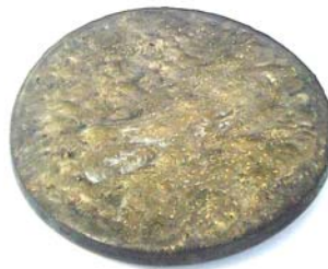
Figura 5 – Corpo de prova com duas camadas de revestimento.
