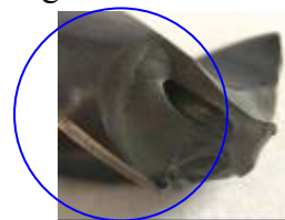
Figura 6. Quebra na ponta da ferramenta.
