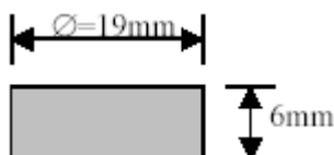
Figura 5. Esquema simplificado da amostra utilizada na usinagem eletroquímica.
