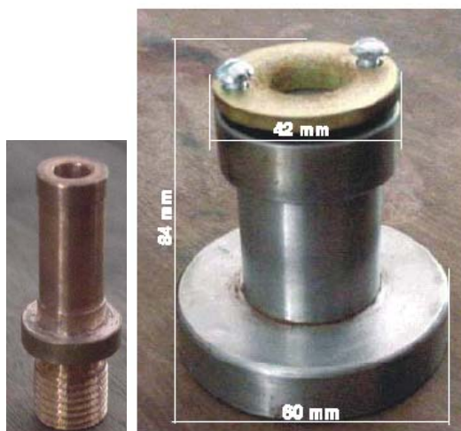
Figura 4. (a) Ferramenta de usinagem eletroquímica (sem isolamento) utilizada nos ensaios (à esquerda). (b) Suporte para fixação da peça (à direita), Silva Neto (2005).
