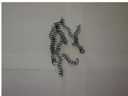
Figura 10. Cavaco formado com velocidades de corte de 50 e 15 m/min, (a) e (b) respectivamente.
