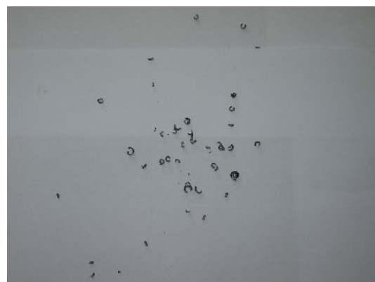
Figura 10. Cavaco formado com velocidades de corte de 50 e 15 m/min, (a) e (b) respectivamente.
