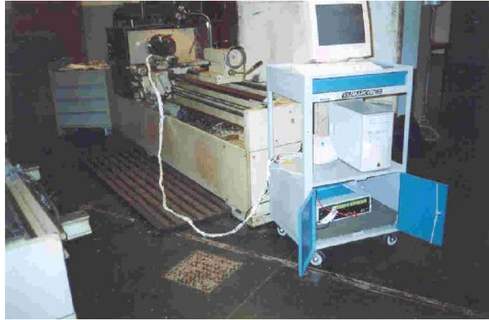
Figura 2. Conjunto de equipamentos utilizados nas medidas de força de corte. Dispositivo para medir força de corte (porta-ferramenta instrumentado), sistema de aquisição e microcomputador utilizado nos ensaios de usinagem.
