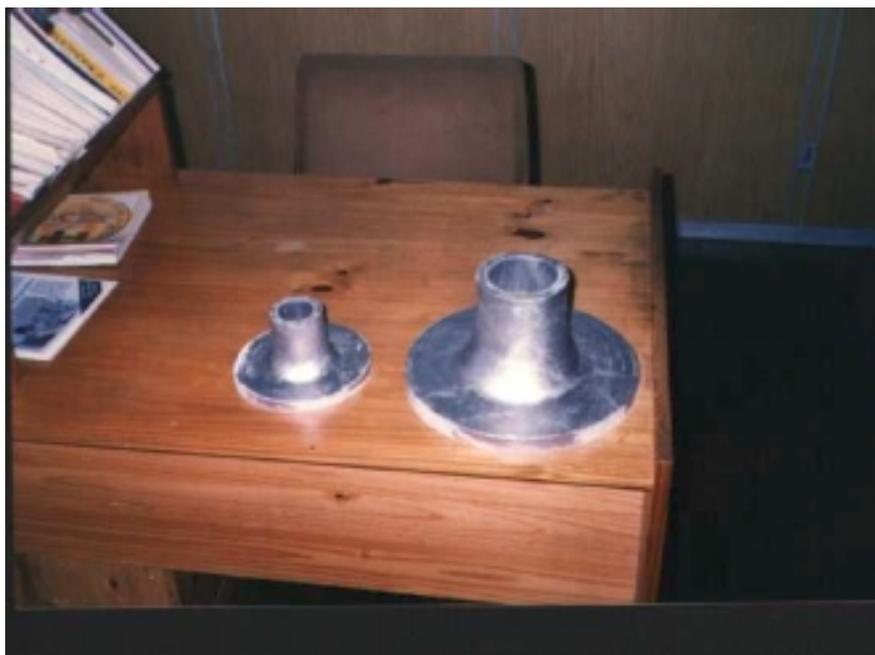
Foto 1 – Bocais fundidos em alumínio, aguardando usinagem.
