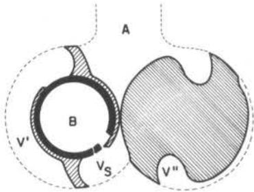
Figura 2. Desenho esquemático da seção transversal do compressor
