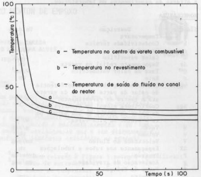
Figura 4. Parada de bomba com o desligamento do reator
