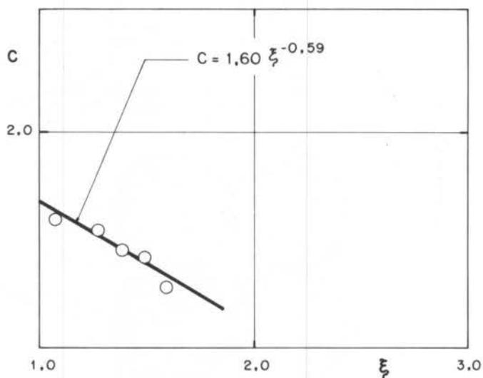
Figura 4. Coeficiente C em função da razão de aspecto
