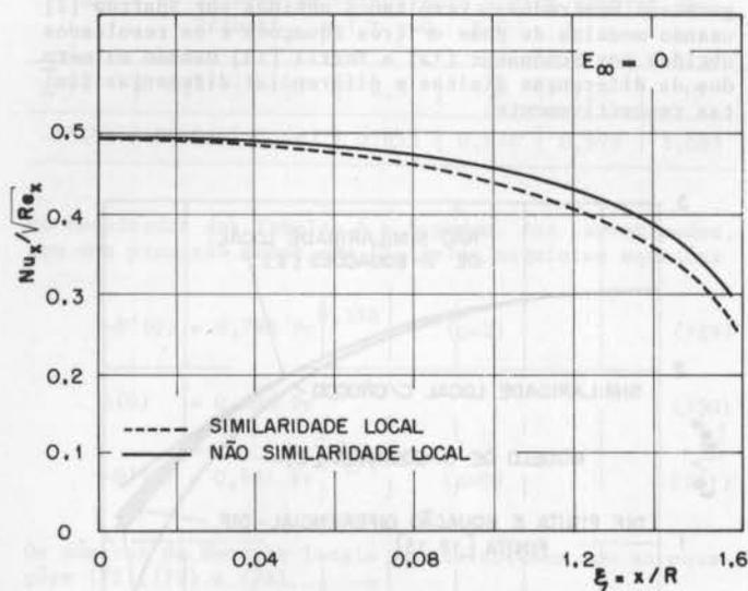
Figura 14.  $Nu_x/\sqrt{Re_x}$  como função de  $\xi$  para o cilindro em escoamento transversal.  $E_\infty = 0$ ,  $Pr = 0,7$ ,  $\Gamma = 0$
