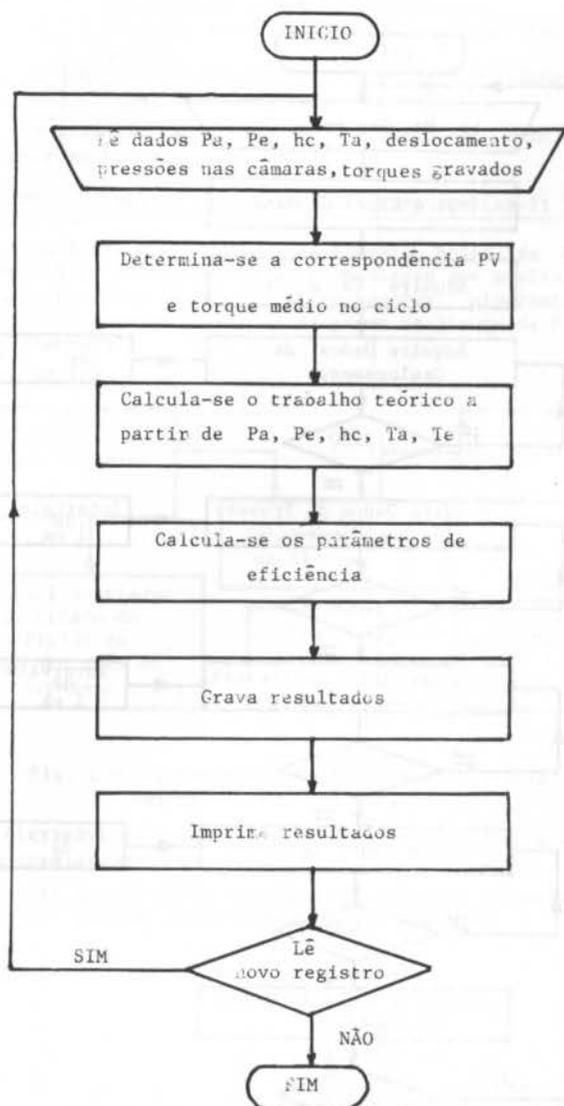
Fig. 4 - Fluxograma do programa de processamento de dados.
