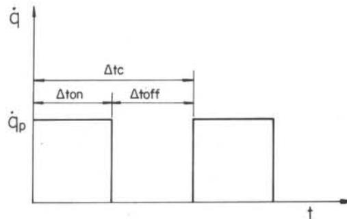
Figura 2. Potência Gerada pelo Componente
