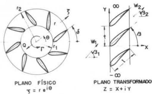
Figura 1. Plano físico da grade circular e plano transformado da grade linear.
