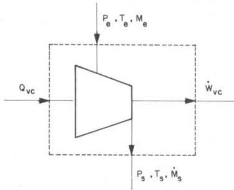
Figura 3. Definição do volume de controle para o compressor
