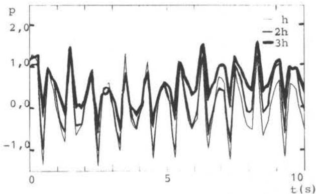
Figura 9. Pressão no ponto crítico da linha para uma variação de cota do reservatório (parada).
