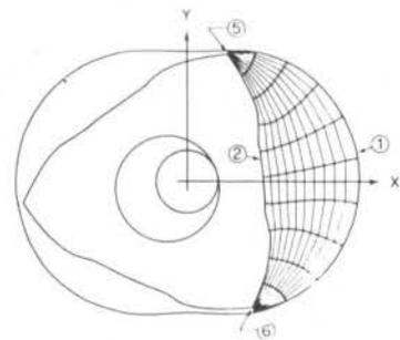
Fig. 12 - Discretização para o problema do escoamento em um motor rotativo.
