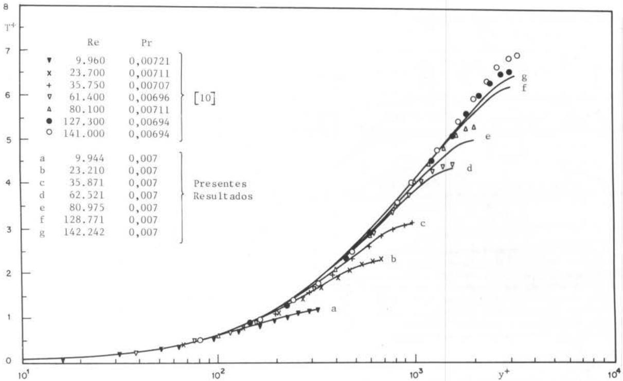
Figura 5. Influência do Número de Reynolds na distribuição de temperatura para escoamento turbulento em tubo para sódio líquido.
