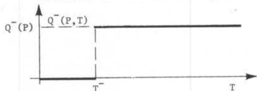
Figura 4. Comportamento da função de acumulação de calor rejeitado no ciclo de Carnot para um gás ideal
