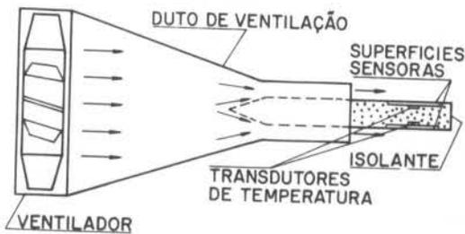
Figura 1. Vista esquemática do radiômetro.
