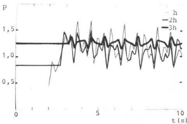
Figura 8. Pressão no ponto crítico da linha para uma variação da altura do reservatório (partida).
