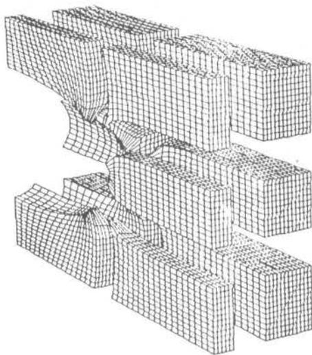
Fig. 17 - Malha tri-dimensional gerada por blocos.
