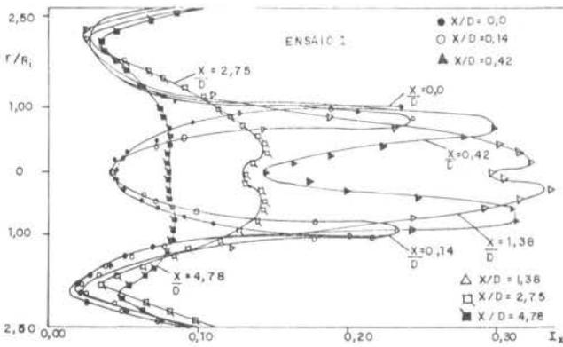
Figura 8 - Perfis de Intensidade de Turbulência
