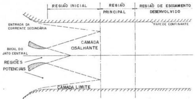
Figura 1. Configuração típica do escoamento
