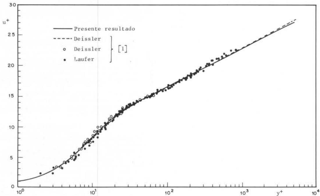
Figura 3. Distribuição de velocidade para escoamento turbulento em tubo.
