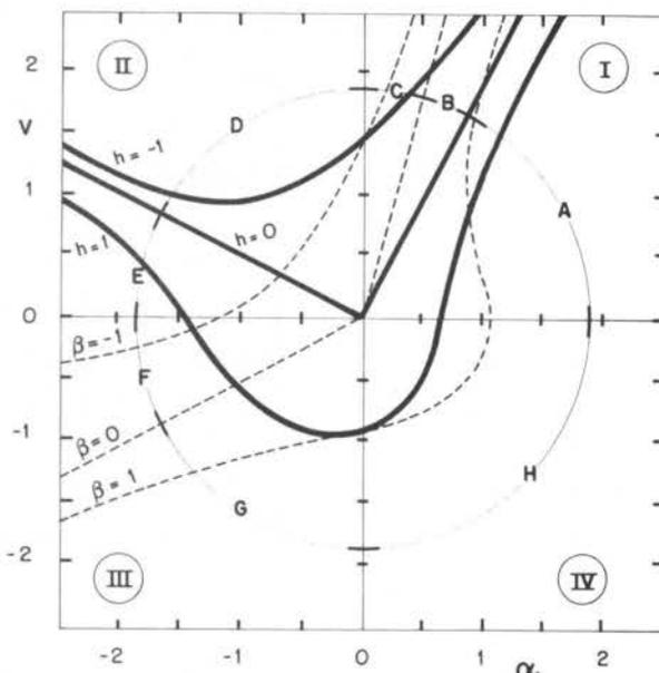
Figura 2. Diagrama Karman-Knapp para operação completa de bomba
