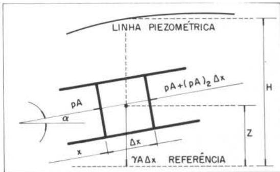
Figura 3. Volume de controle para aplicação das equações de movimento
