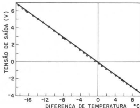
Figura 5. Relação entre o sinal de saída ( $V_L$ ) e as diferenças de temperatura ( $\Delta T$ ).
