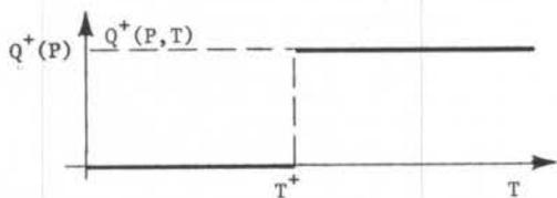
Figura 3. Comportamento da função de acumulação de calor absorvido no ciclo de Carnot para um gás ideal
