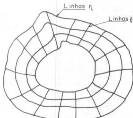
Fig. 3 - Sistema de coordenadas generalizadas.
