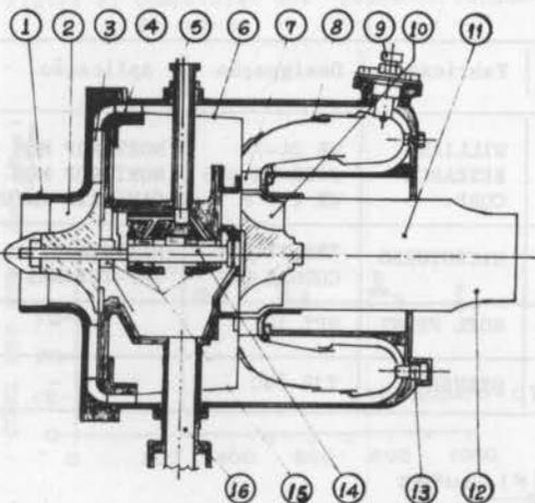
Figura 1. Esquema do Turbojato
