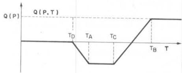
Figura 9. Comportamento da função de acumulação no ciclo de Rankine para um gás ideal com  $C_p$  constante
