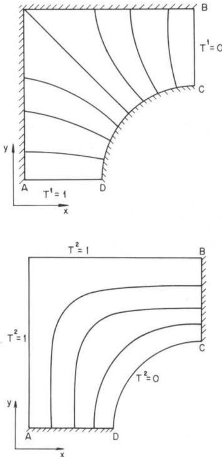
Fig. 5 - Geração do sistema de coordenadas.
