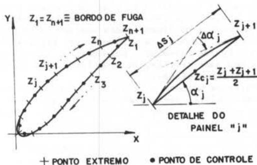
Figura 2. Discretização do perfil aerodinâmico em painéis no plano da grade linear.
