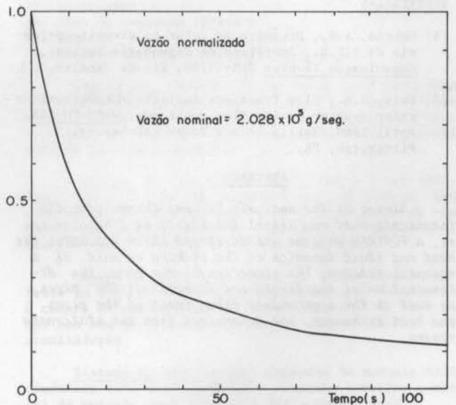
Figura 5. Parada de bomba com o desligamento do reator
