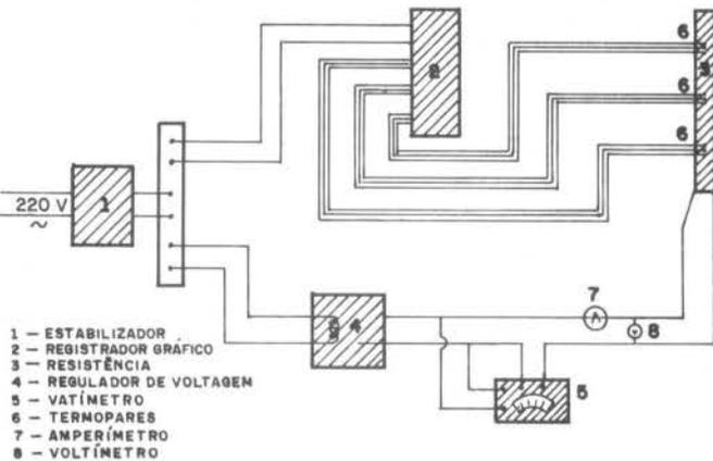
Figura 2. Esquema da bancada experimental.
