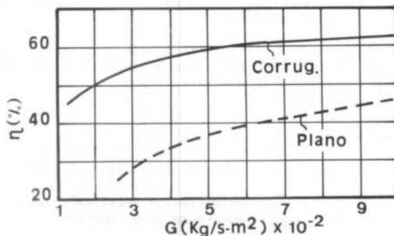
Fig. 9 - Comparação coletor corrugado - coletor convencional plano.
