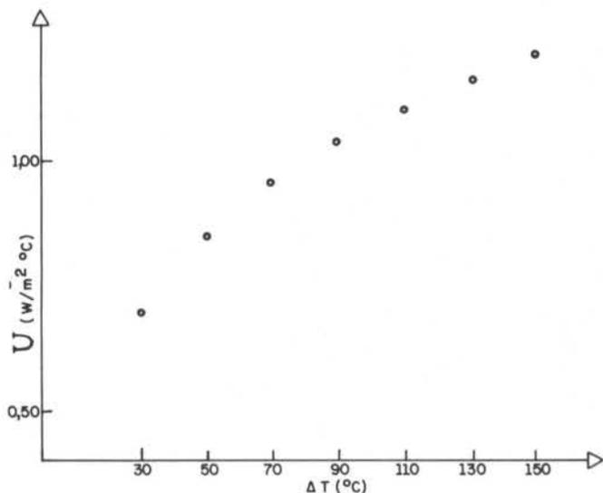
Figura 6. Coeficiente de perdas.
