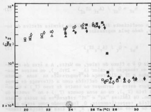
Figura 1. Coeficiente de transmissão de calor versus temperatura na metade do tubo, para ângulos de 40, 60 e 80° e temperaturas na zona fria de 18 e 22°C.
