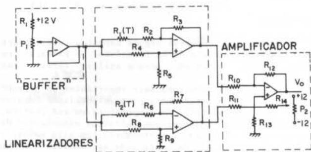
Figura 3. Circuito condicionador de sinal completo.
