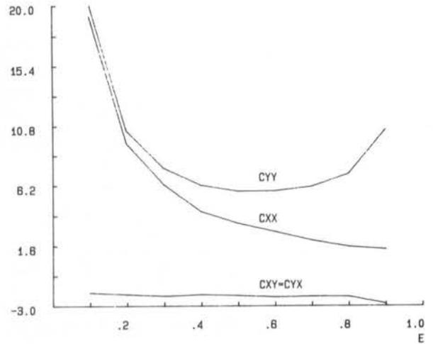
Figura 6. Variação dos Coeficientes de Amortecimento em função de  $\epsilon$ .
