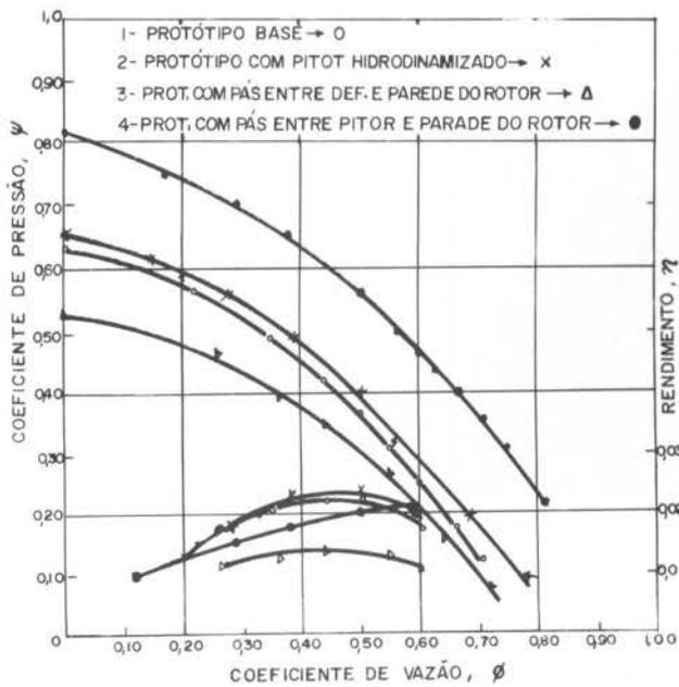
Figura 5 - Características adimensionais para as várias configurações do protótipo
