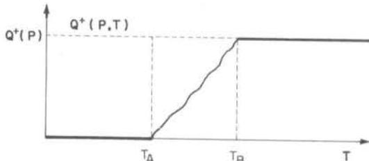
Figura 7. Comportamento da função de acumulação de calor absorvido no ciclo de Rankine para um gás ideal
