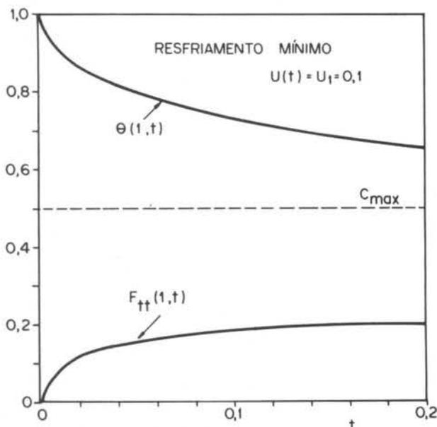
Figura 3. Temperatura e Fator de Tensão Térmica durante transiente com resfriamento mínimo.
