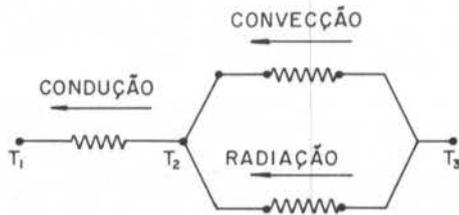
Figura 2. Circuito equivalente do modelo simplificado
