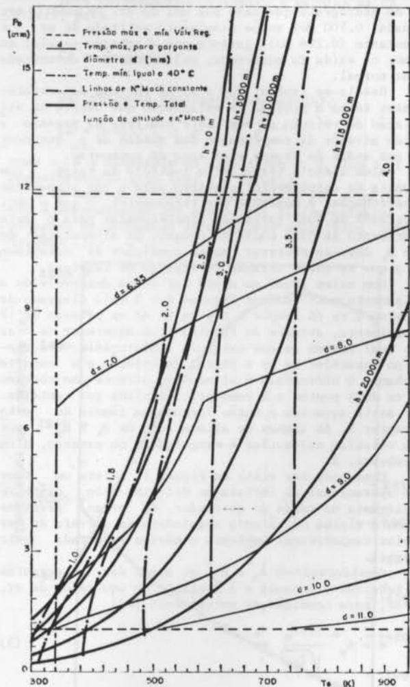
Figura 1. Condições de simulação em função dos parâmetros de voo e envelope de operação da instalação.
