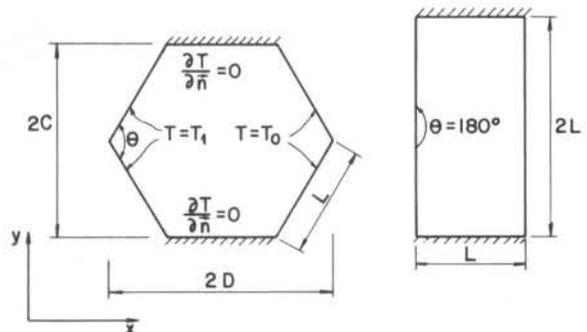
Figura 1. Geometria e condições de contorno
