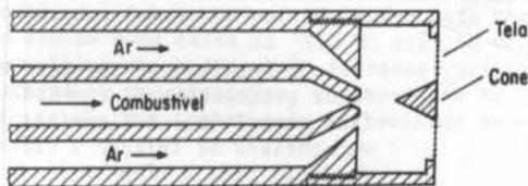
Figura 5. Sistema de Injeção com Dispositivo de Retenção de Chama
