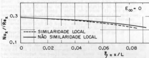
Figura 18.  $Nu_x/\sqrt{Re_x}$  em função de  $\xi$  para o escoamento desacelerado de Howarth.  $E_\infty = 0$ ,  $Pr = 0,7$ ,  $\Gamma = 0$
