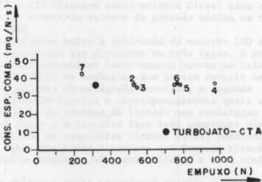
Figura 7. Comparação dos consumos específicos em função do empuxo
