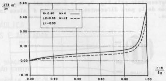
Figura 5. Distribuição do fluxo de calor ao corpo da aleta externa para  $R = 0,60$ ,  $L_1 = 0,0$  e  $L_2 = 0,55$ .
