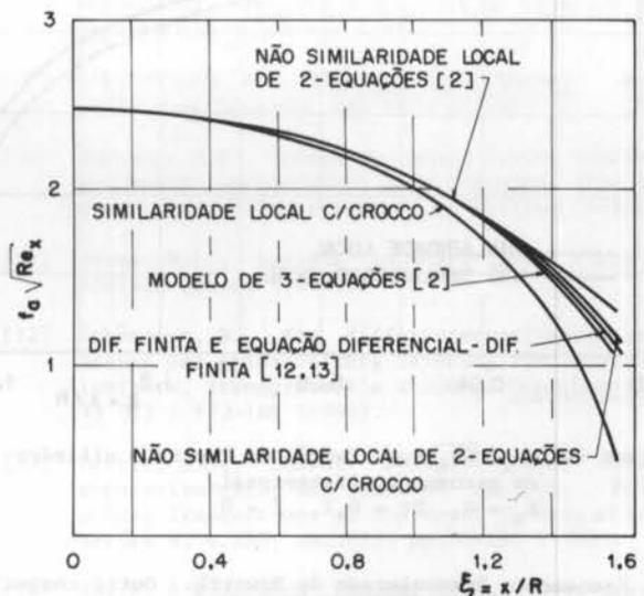
Figura 12. Variação do produto  $f_a \sqrt{Re_x}$  ao longo da superfície de um cilindro em escoamento transversal
