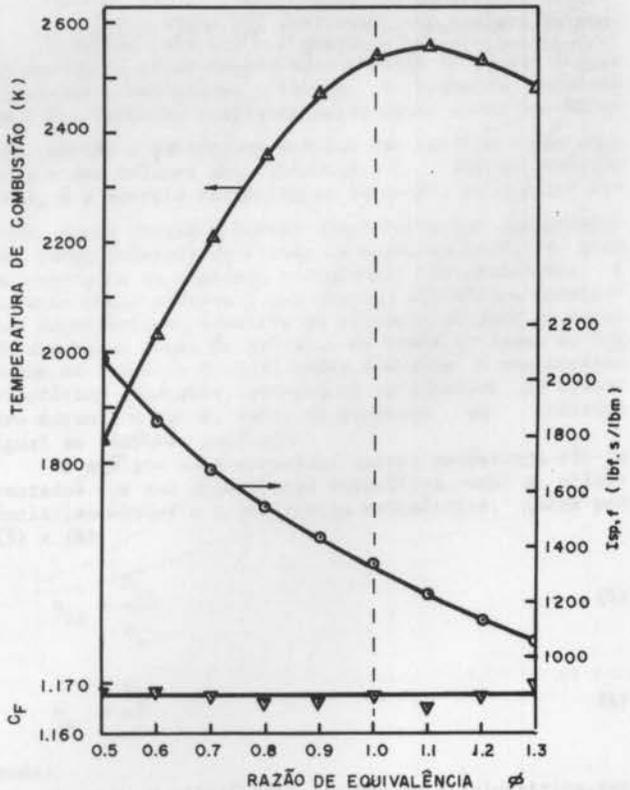
Figura 7. Parâmetros da combustão vs razão de equivalência,  $\phi = CA/(CA)$  estequiométrico.
