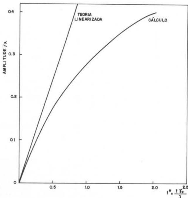
Figura 3. Amplitude máxima da deformação da esteira
