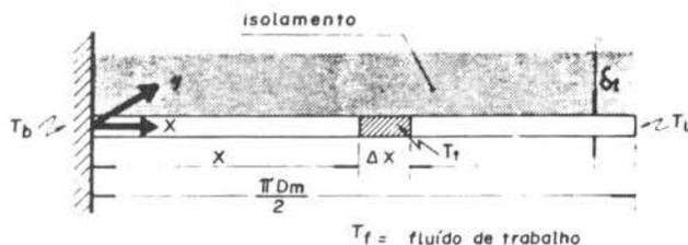
Figura 3. Metade do tubo que conduz o fluido mostrado como uma aleta
