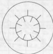
Figura 1. Trocador de calor duplo-tubo-duplo-aletado.
