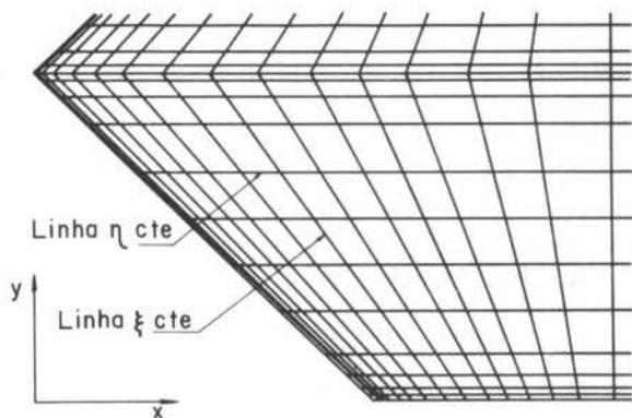
Figura 2. Malha 24x30 do hexágono com  $\theta=90^\circ$
