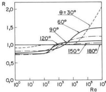
Figura 8. Razão entre a troca de calor por convecção na cavidade hexagonal e na retangular inscrita.
