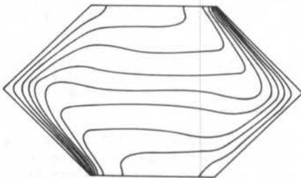
Figura 5. Isotermas para  $Ra=10^5$  e  $\theta=90^\circ$
