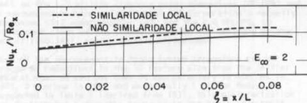
Figura 19.  $Nu_x/\sqrt{Re_x}$  em função de  $\xi$  para o escoamento desacelerado de Howarth.  $E_\infty = 2$ ,  $Pr = 0,7$ ,  $\Gamma = 0$
