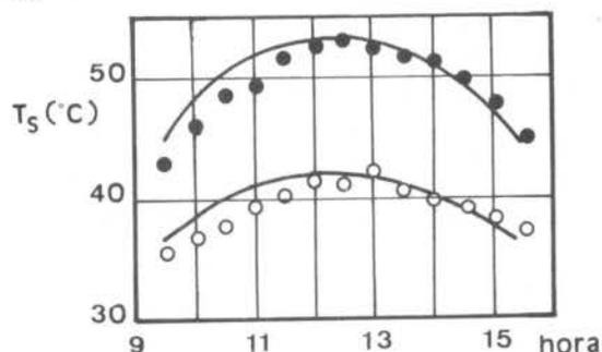
Fig. 7 - Resultados teóricos e experimentais - aquecimento de ar na entrada.
