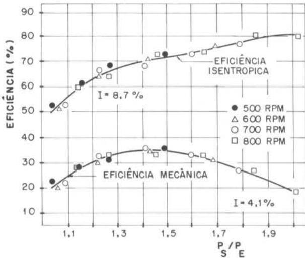
Figura 5. Curvas de variação de eficiência isentrópica e eficiência mecânica com relação de pressões
