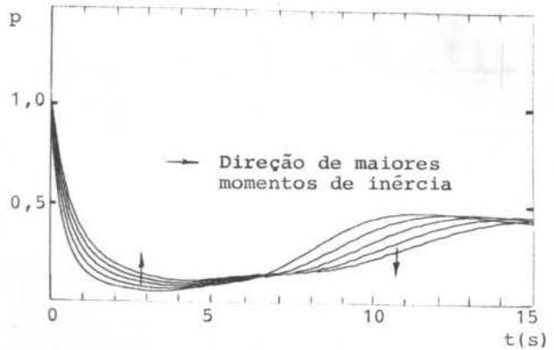
Figura 6. Pressão na bomba em função da variação do momento de inércia (Para Parada).
