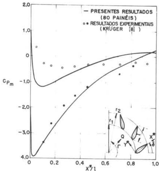
Figura 5. Distribuição de pressões para o perfil Joukowski simétrico em grade circular:  $y^*/l = \pm 0,052$  em  $x^*/l = 0,31$ ,  $\delta = 36,88^\circ$ ,  $r_1/r_2 = 0,682$ ,  $N = 12$ ,  $\Gamma/Q = 0,86$ .
