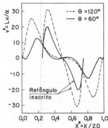
Figura 3. Perfis de velocidade para  $Ra=10^4$
