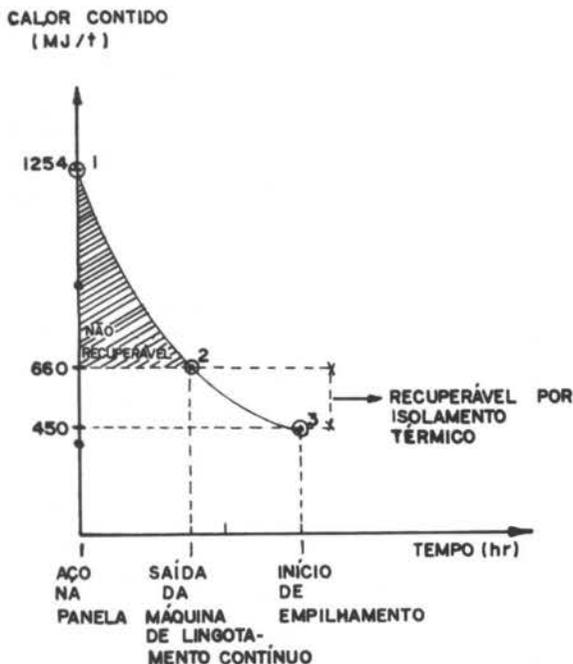
Figura 2 . Queda do Calor Contido na Placa Individual na primeira Fase do Processo
