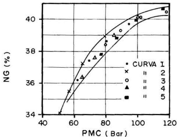
Figura 3. Eficiência em função da pressão máxima
