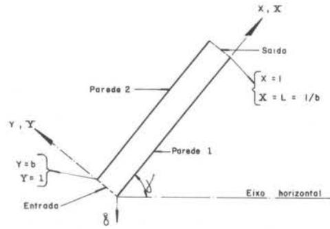
Fig. 1 - A Região de Fluxo: Corte Vertical
