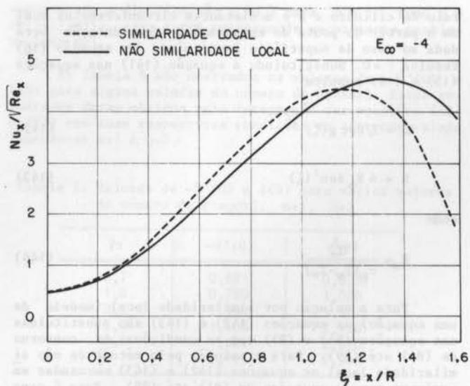
Figura 13.  $Nu_x/\sqrt{Re_x}$  como função de  $\xi$  para o cilindro em escoamento transversal.  $E_\infty = -4$ ,  $Pr = 0,7$ ,  $\Gamma = 0$
