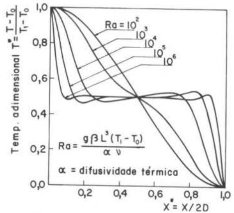
Figura 6. Perfis de temperatura para  $\theta=90^\circ$
