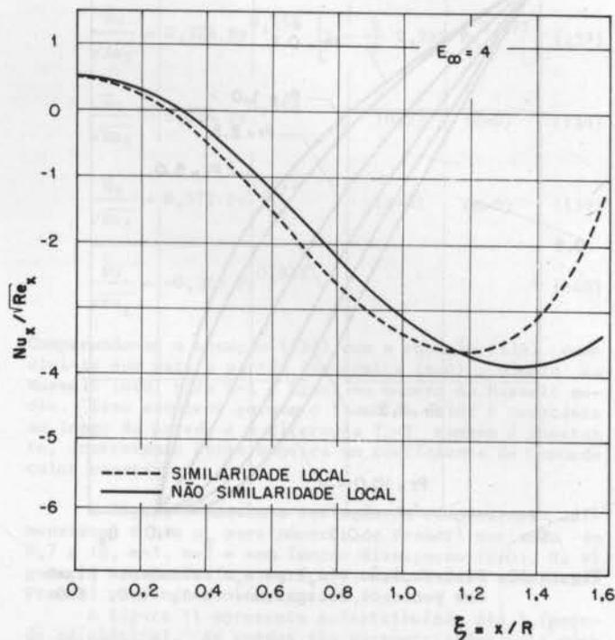
Figura 15.  $Nu_x/\sqrt{Re_x}$  como função de  $\xi$  para o cilindro em escoamento transversal.  $E_\infty = 4$ ,  $Pr = 0,7$ ,  $\Gamma = 0$
