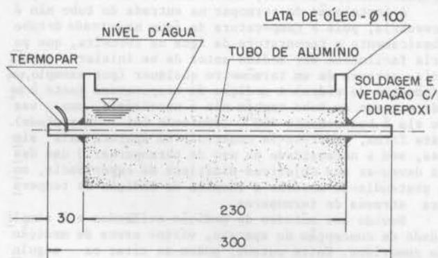
FIG. 2a Corte e dimensionamento do recipiente e do tubo
