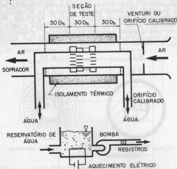
Figura 2. Vista esquemática do trocador de calor e periféricos
