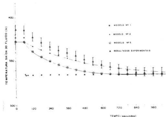
Figura 5. Resfriamento, comparação dos modelos com dados experimentais
