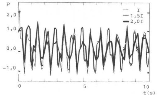
Figura 7. Pressão no ponto crítico da linha para uma variação do momento de inércia das partes girantes (para parada).
