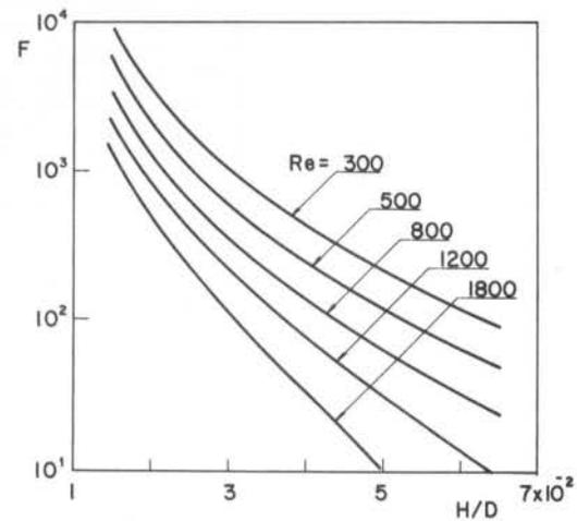
Figura 5. Força axial resultante atuando na palheta
