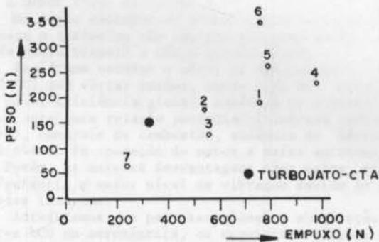
Figura 6. Comparação dos pesos em função do empuxo
