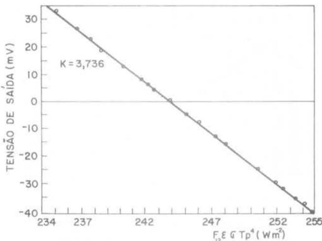
Figura 7. Obtenção da constante de calibração
