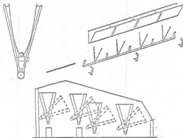
Figura 1. Coletor CPC e estufa do sistema de produção de gelo (Projeto CONSOL)
