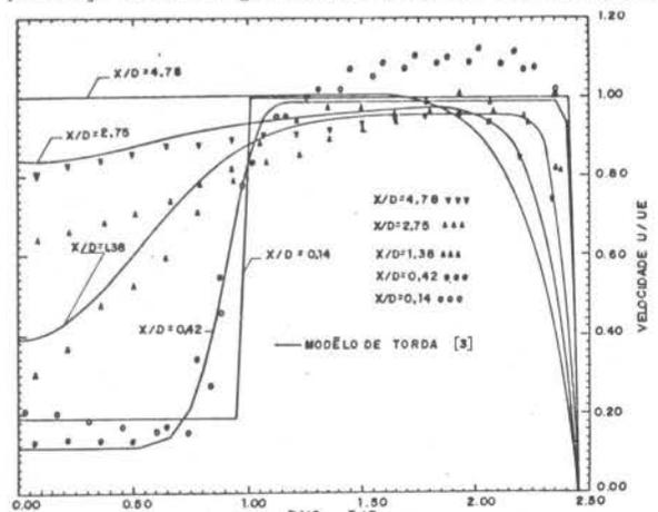
Figura 3 - Resultados do Ensaio 1:  $U_e/U_i = 5.31$
