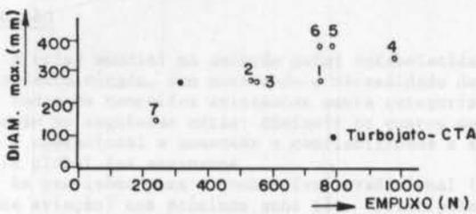
Figura 5. Comparação dos diâmetros máximos em função do empuxo
