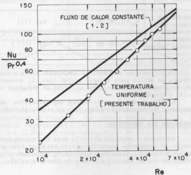
Figura 4. Comparação dos dados de Nusselt da literatura para fluxo de calor constante com os obtidos no presente trabalho (temperatura uniforme)
