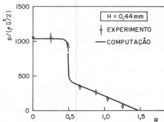
Figura 3. Comparação entre os resultados numéricos e experimentais;  $Re=1326$  e  $H/D=0,0147$ .
