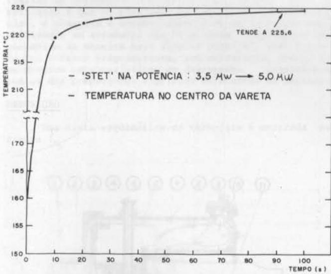
Figura 3. 'STEP' na potência com a bomba funcionando normalmente
