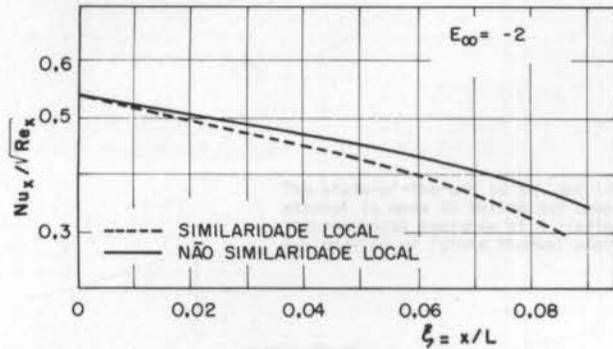
Figura 17.  $Nu_x/\sqrt{Re_x}$  em função de  $\xi$  para o escoamento desacelerado de Howarth.  $E_\infty = -2$ ,  $Pr = 0,7$ ,  $\Gamma = 0$
