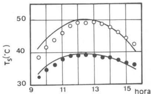
Fig. 6 - Resultados teóricos e experimentais ( $G = 0,09 \text{ Kg/s} \cdot \text{m}^2$  (●),  $G = 0,035 \text{ Kg/s} \cdot \text{m}^2$  (○), simulação (—))
