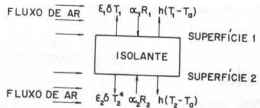
Figura 2. Balanço de energia no sensor.
