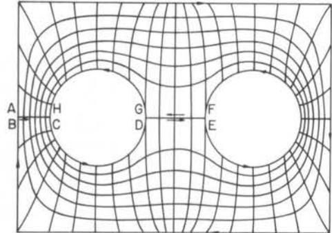
Fig. 10 - Discretização para uma geometria multiplamente conexa.
