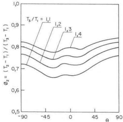
Figura 3. Temperatura na interface entre o sólido e o fluido (superfície 2)
