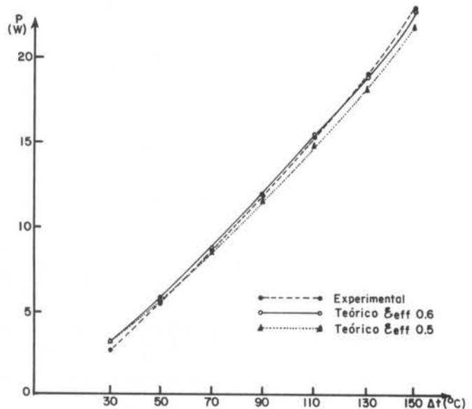
Figura 5. Resultados experimentais e teóricos das perdas de energia térmica.
