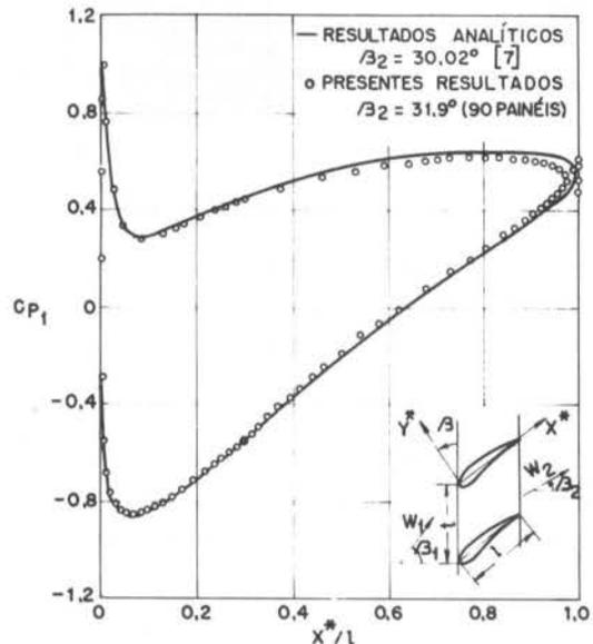
Figura 3. Distribuição de pressões para o perfil analítico em grade linear:  $\beta = 37,5^\circ$ ,  $\beta_1 = 53,5^\circ$ ,  $t/l = 0,9901573$ ,  $C_{p1} = 1 - (\gamma/W_1)^2$ .
