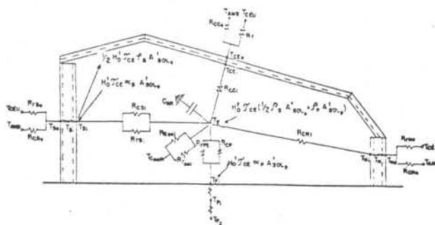
Figura 2. Esquema geral dos nós e resistências térmicas na estufa.
