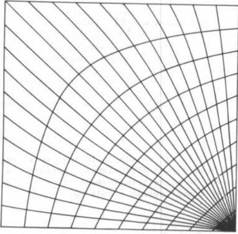
Fig. 6 - Coordenadas generalizadas com polo.
