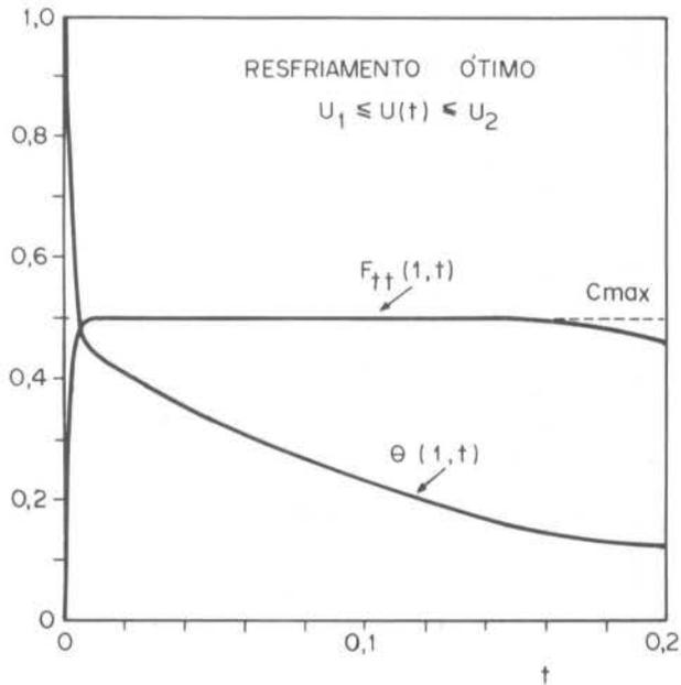
Figura 6. Temperatura e Fator de Tensão Térmica durante transiente com resfriamento ótimo.
