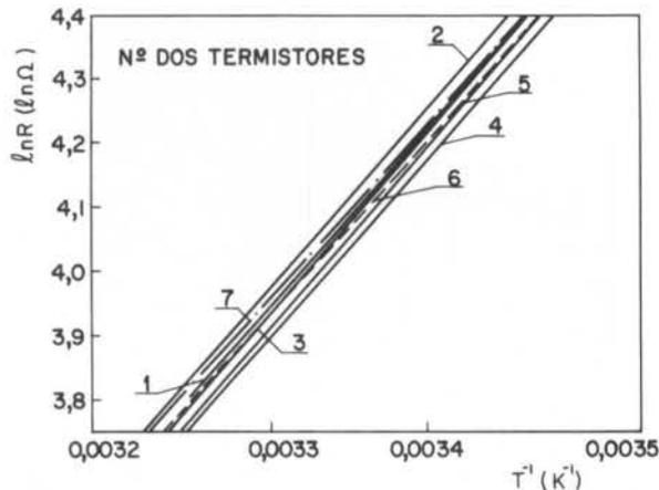
Figura 4. Relação resistência-temperatura.
