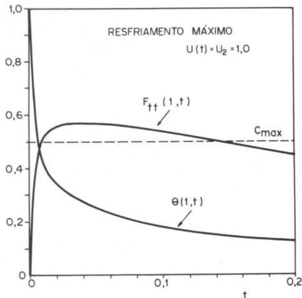
Figura 4. Temperatura e Fator de Tensão Térmica durante transiente com resfriamento máximo.
