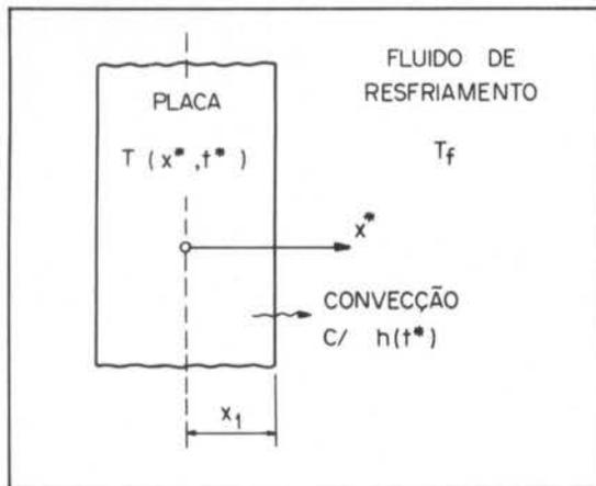
Figura 1. Notação para análise de transiente térmico em placa plana.
