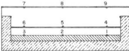
Figura 3. Pontos de medida de temperatura.
