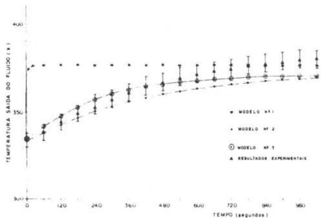
Figura 4. Aquecimento, comparação dos modelos com dados experimentais
