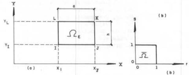
Fig. 2a. a) O elemento finito E; b) O elemento normalizado
