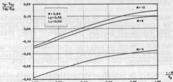
Figura 4. Distribuição de temperatura ao longo da aleta externa para  $R=0,60$ ,  $L_1 = 0,0$ ,  $L_2 = 0,55$ .
