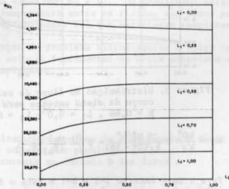
Figura 7. Variação do número de Nusselt do duto interno com o comprimento da aleta externa para  $M=12$ ,  $R=0,60$  e  $k_f/k_s=0,02$ .
