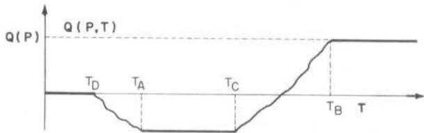
Figura 8. Comportamento da função de acumulação no ciclo de Rankine para um gás ideal
