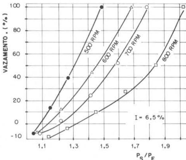
Figura 4. Variação do vazamento com a relação de pressões a rotação constante
