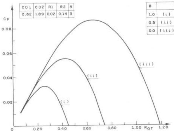
Figura 7. Rotor com proteção - efeito do parâmetro B.
