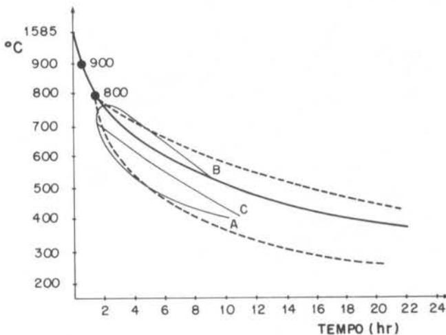
Figura 4. Posicionamento das curvas de temperatura previstas pelo modelo comparadas com dados experimentais
