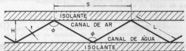
Figura 1. Seção transversal do trocador de calor
