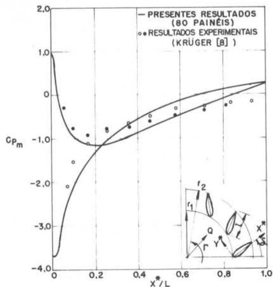
Figura 4. Distribuição de pressões para o perfil Joukowski simétrico em grade circular:  $y^*/l = \pm 0,052$  em  $x^*/l = 0,31$ ,  $\delta = 36,88^\circ$ ,  $r_1/r_2 = 0,682$ ,  $N = 12$ ,  $\Gamma/Q = 0,46$ .
