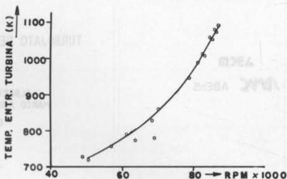
Figura 3. Temperatura na entrada da turbina.
