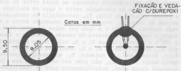
FIG. 2b - Seção reta do tubo ampliada
