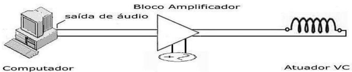
Figura 2 – Esquema de montagem computador-amplificador-atuador
