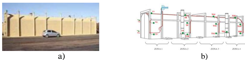
Figura 1 – a) Forno de alvenaria modelo RAC220; b) Disposição dos sensores através do forno
