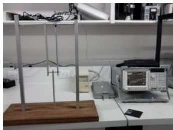
Figura 2 – Foto da montagem para instrumentação do pêndulo.
