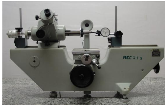
Figura 1 – Montagem realizada para a calibração do relógio comparador.
