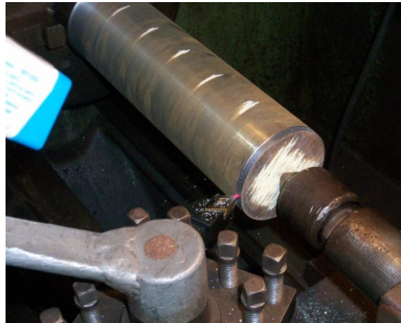
Figura 1 – Medição da temperatura de corte durante e usinagem a seco do aço ABNT 1020.
