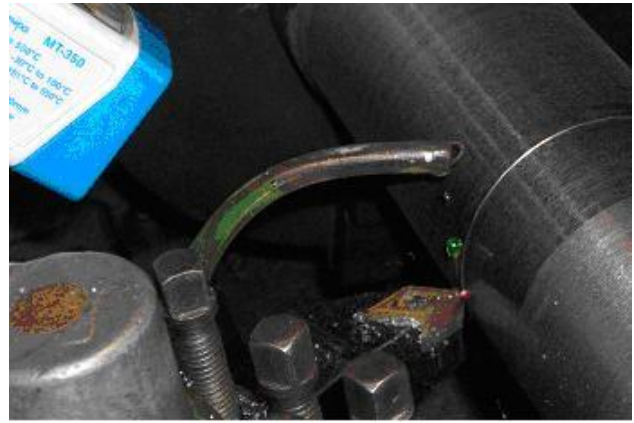
Figura 2 - Usinagem por gotejamento do aço ABNT 1045
