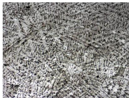
**Figura 02** – Aspecto microestrutural da zona de fusão. A fase dendrítica, mas clara, é entremeada pela presença de uma segunda fase lamelar (mais escura). Aumento de 100X.
