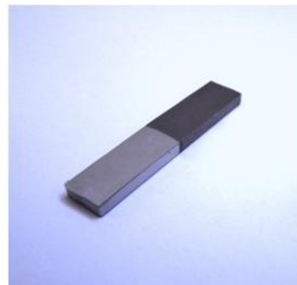
Figura 2 – Amostra injetada contendo dois materiais combinados.
