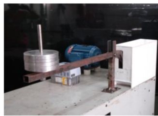
Figura 1 – Etapas construtivas da Máquina de Desgaste Abrasivo construída para o experimento.
