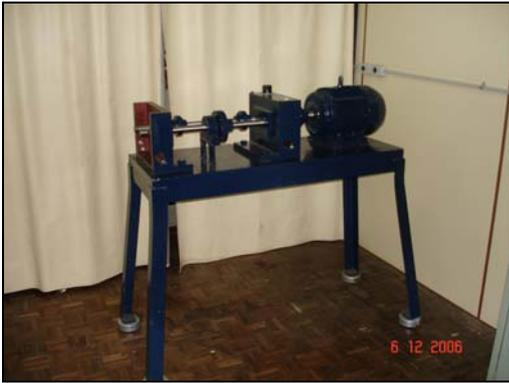
Figura 1 - Máquina tipo FZG desenvolvida pela equipe do LASC, com a câmara de ensaio aberta.
