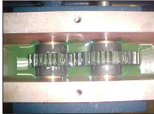
Figura 2 – Detalhe da câmara contendo as engrenagens (corpos-de-prova), com lubrificante.
