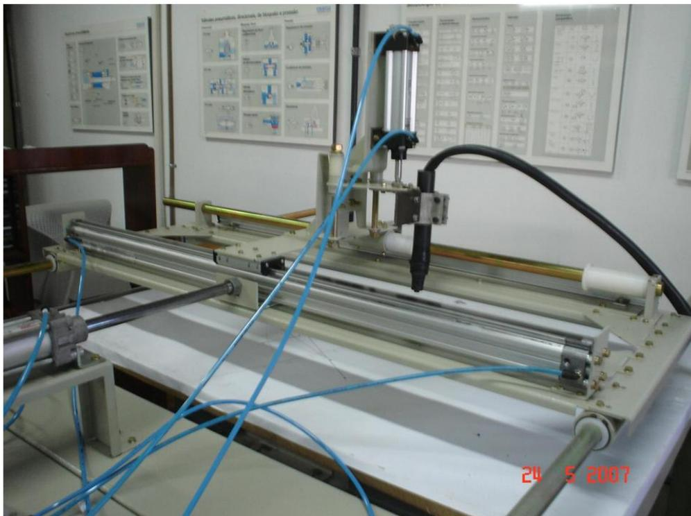
Figura 9: O sistema de corte adaptado no manipulador robótico
