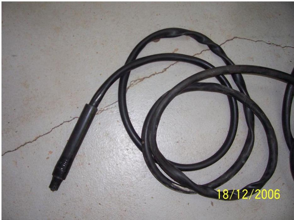
Figura 5: Tocha de corte mecanizada
