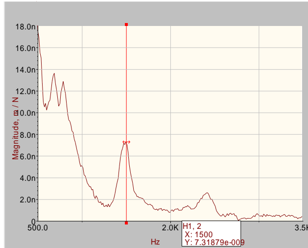
Figura 10: FRF medida na extremidade da fresa S1.
