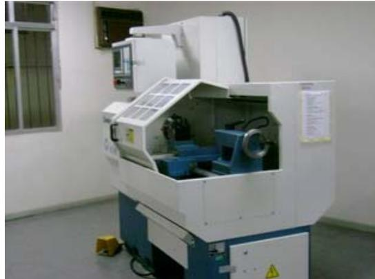
Figura 5: Torno CNC utilizado para o experimento.
