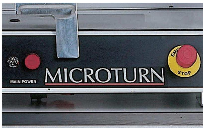
Figura 6: Parada de emergência
