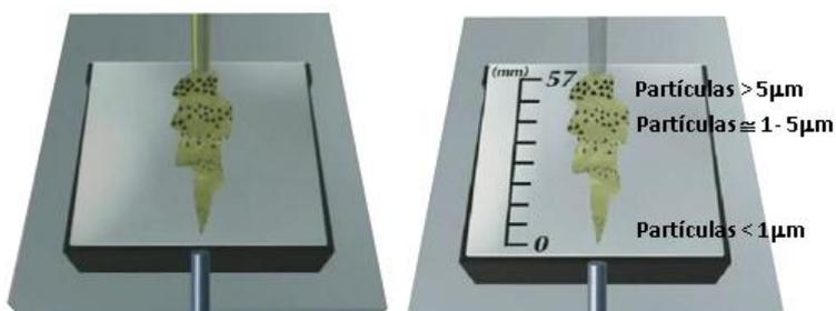
**Figura 3. Esquema de deposição das partículas metálicas sobre a lâmina de vidro (Weber et al. 2010).**
