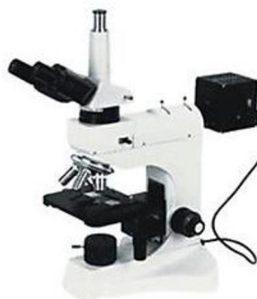
**Figura 6. Microscópio metalográfico e biológico**
