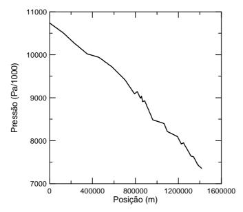
Figura 3. Variação da pressão para vazão de 81,5 kg/s e perfil até Penápolis
