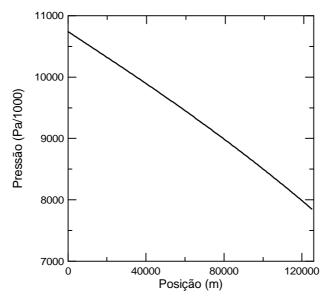
Figura 2. Variação da pressão para vazão de 262,3 kg/s e perfil até Izozog
